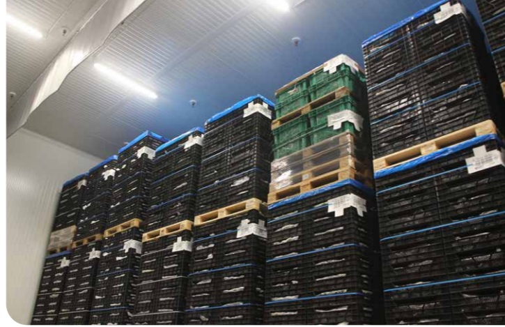
De palletten worden zo optimaal en uniform mogelijk gestapeld in de koelcel zodat de luchtstroom nergens wordt geblokkeerd. Wanneer van een bepaalde partij de laatste pallet niet volledig is gevuld, dan wordt die opgevuld met palletten omwikkeld met plasticfolie.
