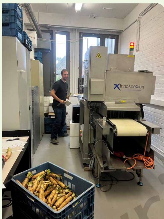
Het röntgensysteem, gemonteerd op een transportband, genereert 2D-beelden met een snelheid die geschikt is voor sorteertoepassingen.
