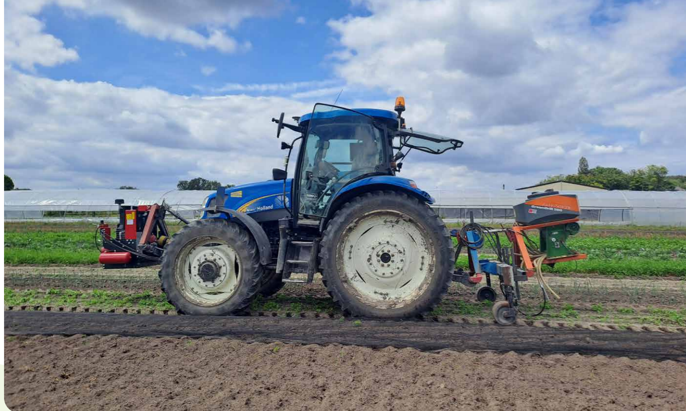
Bij de nieuwe wiedztraaltechniek wordt in de fronthef een compressor gedragen die de zandstraalpistoelen achteraan de machine van lucht voorziet. De partikels worden gravitair aangevoerd vanuit een oude meststofstrooier.
