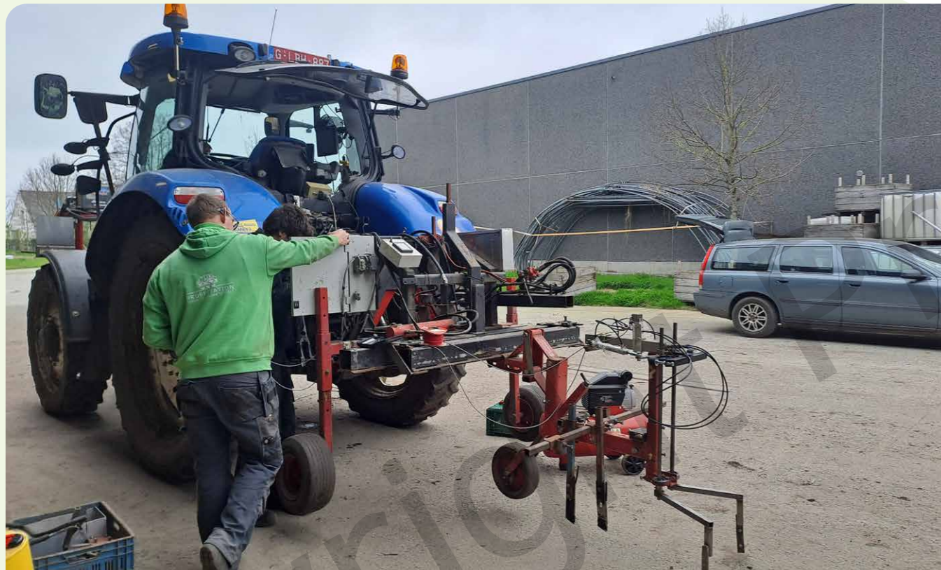
Op de schoffelmachine worden twee messen door pneumatische cilinders in en uit de rij gebracht op basis van de rtk-gps-positie. Op de foto zijn de vaste schoffelmessen voor tussen de rij nog niet gemonteerd.
